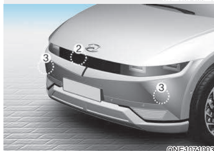
[1]: камера переднего вида, [2]: передний радар, [3]: передний угловой радар
