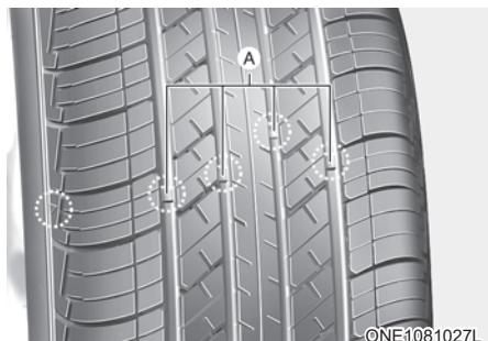
[A]: индикатор износа протектора
